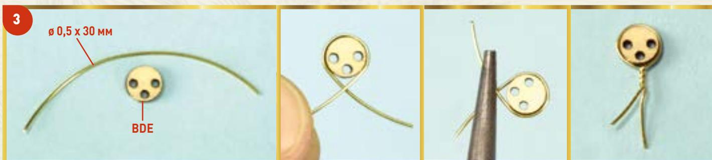
**3** Извлеките юферс BDE из деревянной матрицы, полученной вами с выпуском 122, и возьмите латунную проволоку диаметром 0,5 мм, которая прилагалась к выпуску 125. Отрежьте от этой проволоки отрезок длиной около 30 мм. Обвяжите юферс проволокой и скрутите ее концы, сделав 2–3 оборота. Проследите, чтобы отверстия юферса располагались относительно концов проволоки так, как показано на фотографиях.
