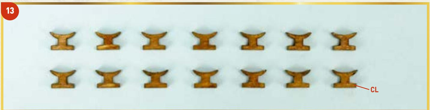
**13** Извлеките 14 крепительных уток (детали CL) из деревянной матрицы, полученной с выпуском 127. Обработайте эти детали надфилем, покройте морилкой цвета «орех» и отложите до того времени, когда они вам понадобятся.
