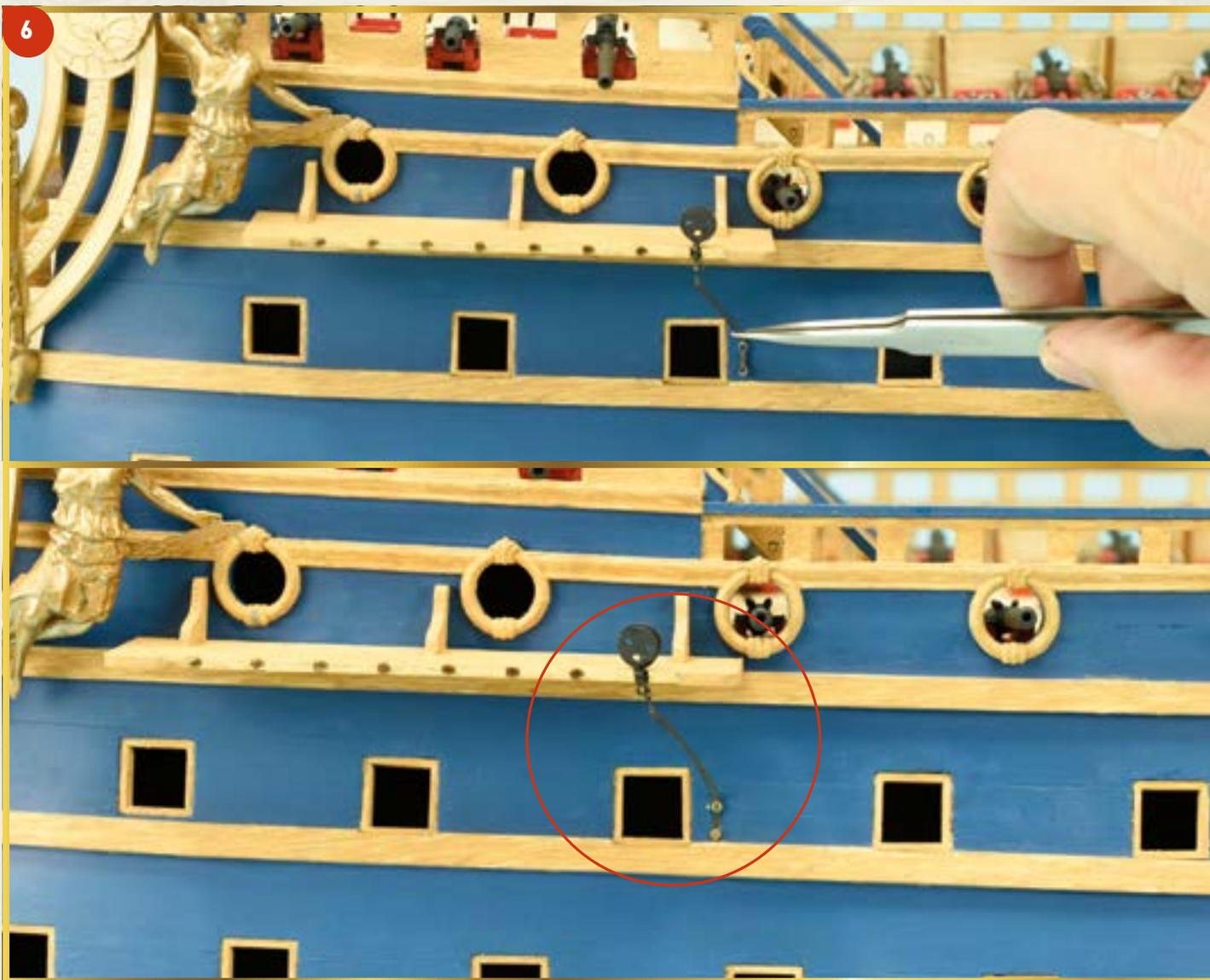
**6** Установите вант-путенс с юферсом в крайнюю правую прорезь левого руслена фок-мачты. Двумя гвоздиками прикрепите к корпусу нижний конец вант-путенса, следя за тем, чтобы он находился справа от расположенного ниже порта: таким образом вант-путенс не закроет порт.
